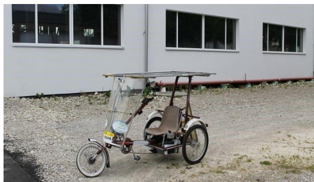
Ultraleichtbau und mit dachintegriertem Solarmodul
