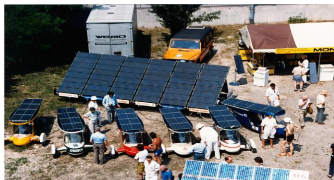
Tour de Sol 86: Mobile Solartankstellen mit Horlacher Solarmobilen
